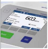
您可以选择显示模式:采用标准视图时,所有信息清晰可见;切换到超级视图(uFocus<sup>TM</sup>)后,只显示最重要的信息,避免受到次要信息的影响。
